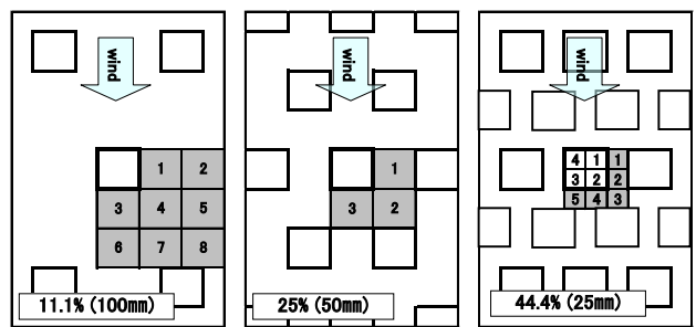
Fig.8 千鳥配列の床面測定点
