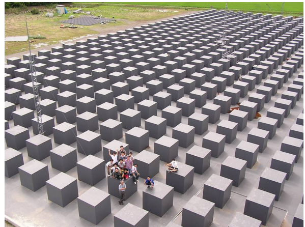
図6 スケールモデルを用いたヒートアイランド屋外実験施設 (日本工業大学内)
