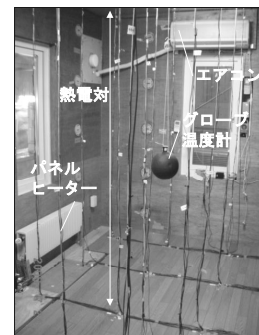
写真 1 LV 室内状況
