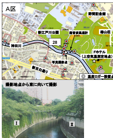
図 1. A 区の測器配置と護岸の状況
