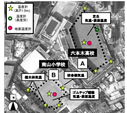
図1 測定場所と測器配置図
