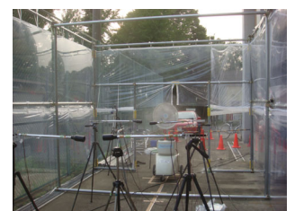
写真2 ビニールハウスを用いた屋外噴霧実験
