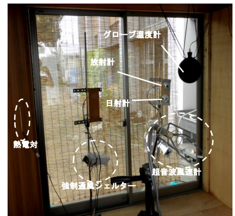
写真3 測定機器の設置状況
