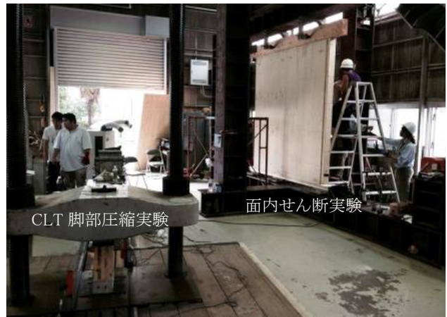
Fig. 14 耐力壁の面内せん断実験(右奥)と CLT 脚部の圧縮実験(左手前)を同時進行
