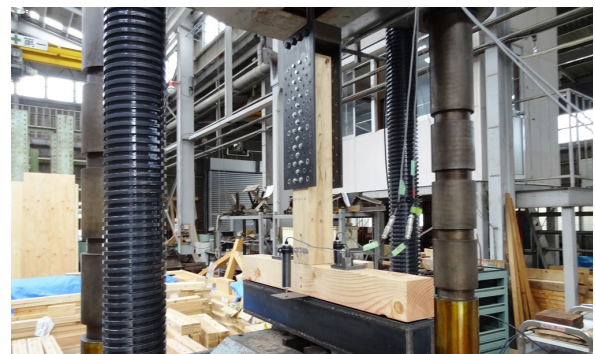
Fig. 15 汎用的な木造住宅の接合部を高強度化
