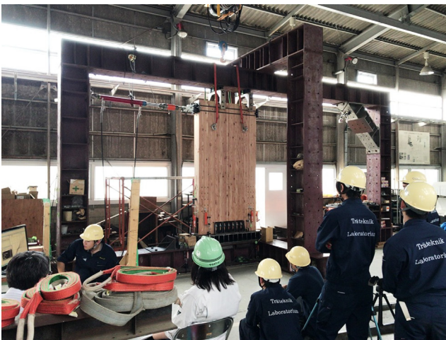
Fig. 19 木造ビル用の壁柱ラーメン構造の開発
