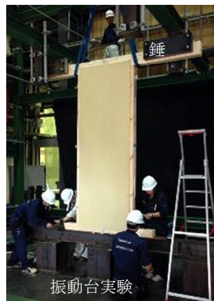
Fig. 13 大地震を再現 振動台実験(京大防災研)
