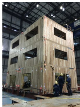
Fig. 8 CLT 振動台実験
