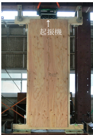
Fig. 12 交通振動を再現 起振機で劣化促進(日工大)
