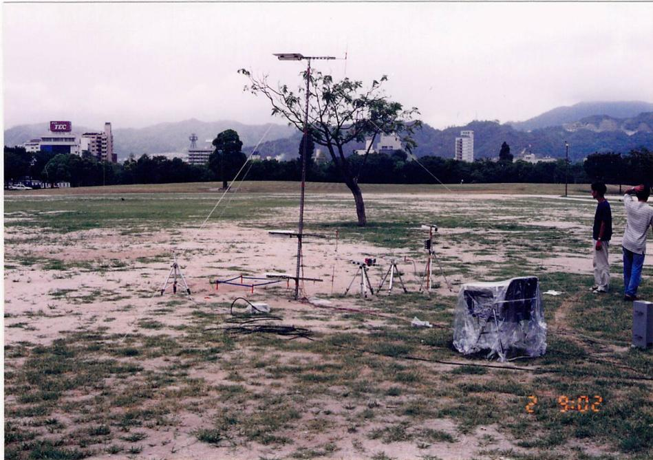
写真-1. 裸地における熱収支・風速鉛直分布観測点（ポイントA）
