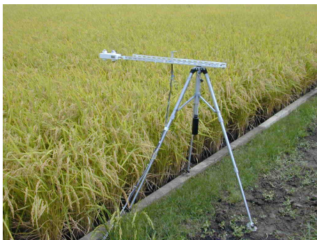
写真 2-9 超短波放射計の設置状況
