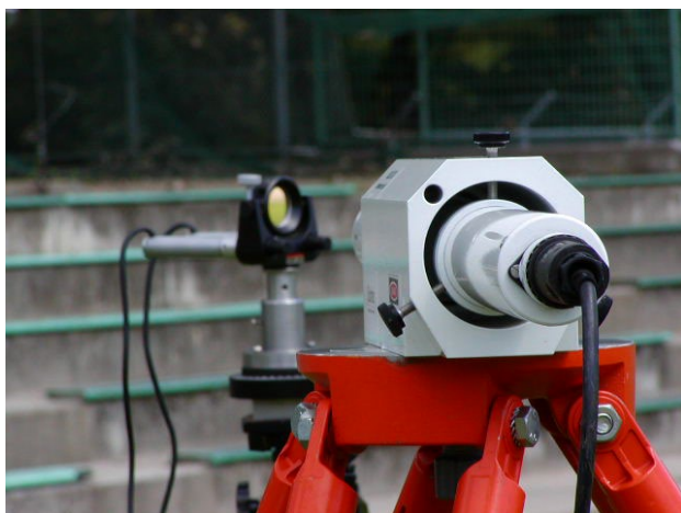
写真5-6 送信側ミラーの設置状況
