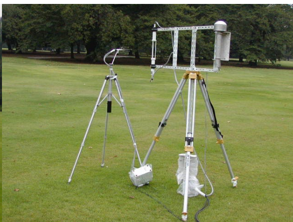
写真2-3. 超音波風速温度計と湿度変動計
