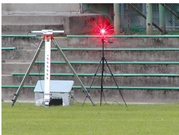
写真5-7 送信側ミラーからのレーザー光
