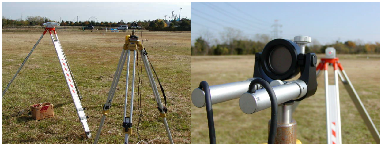
写真5-19 パターン3での測定状況（送信器とミラー）
