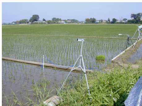
写真 2-8 デジタル温湿度計の設置状況
