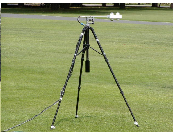
写真2-5. 長短波放射収支計
