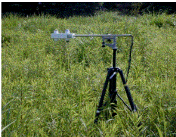
写真 2 - 18 長短波放射計設置状況
