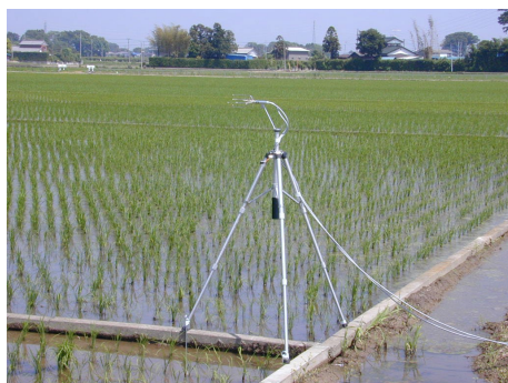
写真2-7 超音波風速温度計の設置状況
