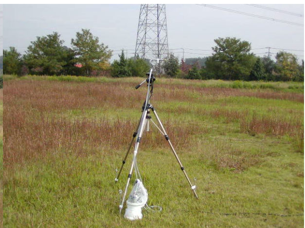
写真5-14 パス中心に設置した超音波風速計
