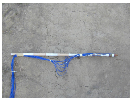
写真 2-12 熱電対を取り付けた杭と設置の状況
