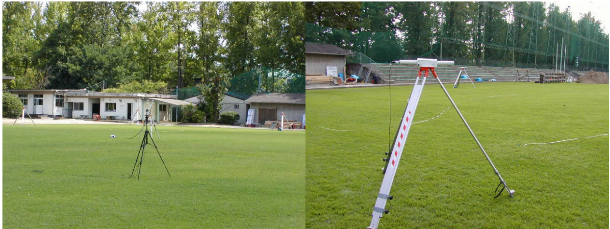
写真5-11 V字測定の設置状況（左：ミラー後方から見た様子、右：手前が受信器・奥が送信器）
