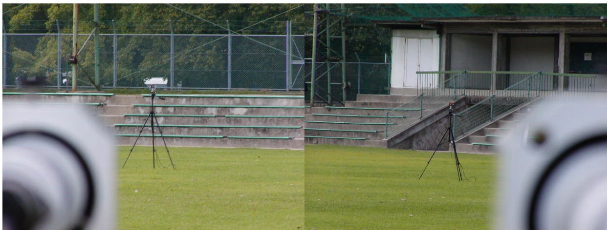
写真5-12 V字測定の状況（左：送信器からみたミラー、右：受信器からみたミラー）
