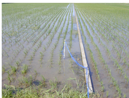
写真 2-12 熱電対を取り付けた杭と設置の状況
