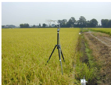
写真2-7 超音波風速温度計の設置状況
