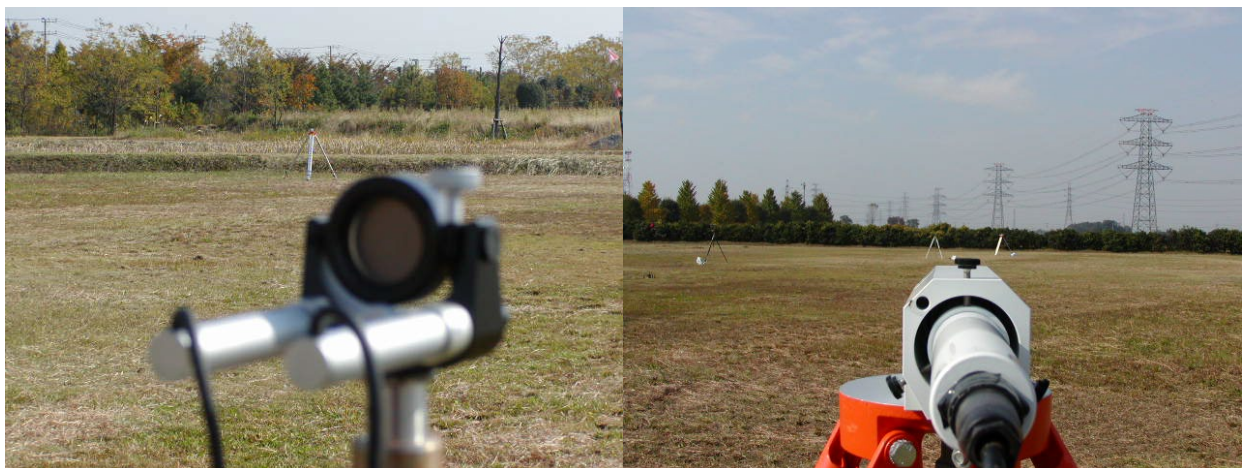
写真5-17 パターン2での測定状況（左：ミラーから受信器、右：受信器からミラー）
