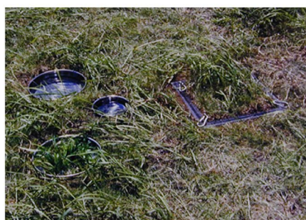
写真 3-4 簡易ライシメータの設置状況
