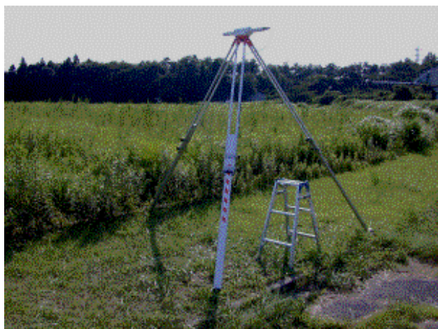
写真 2 - 19 シンチロメータ設置状況
