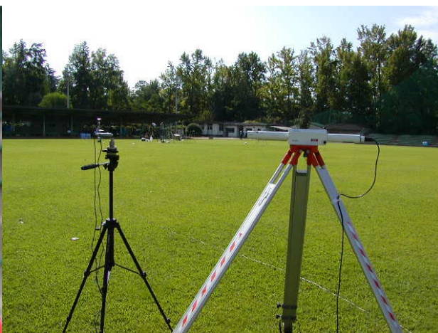
写真5-6 送信側ミラーの設置状況
