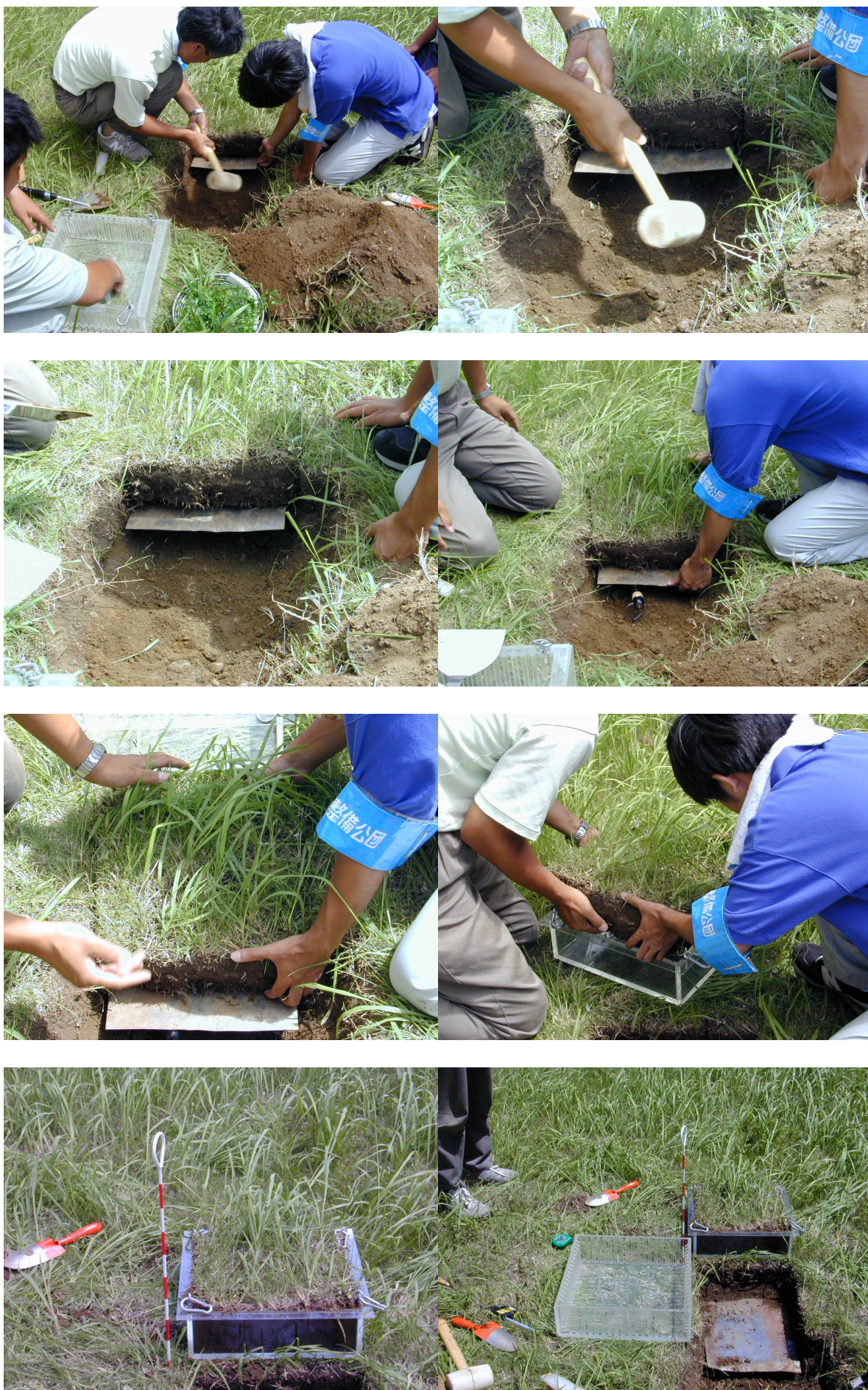
写真 3-2 草地面蒸発散測定のための簡易ライシメータの作成状況
