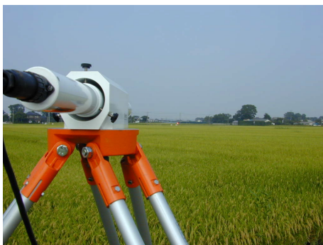
写真 2-10 シンチロメータの設置状況
