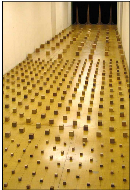
写真2.3 ラフネス配置状況
