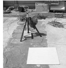
Fig.9 濾紙を用いた物質伝達率の測定
