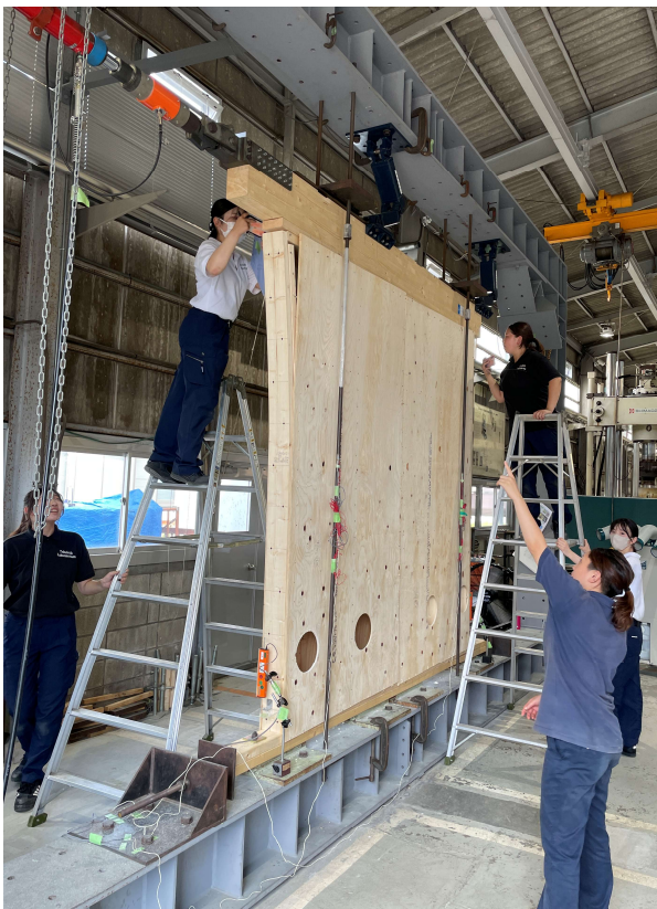
写真 11 耐力壁実験の様子
